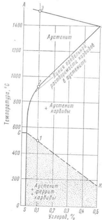
Рис. 4. Псевдобинарная диаграмма состояния стали типа 18-8 с разным содержанием углерода (упрощенная).
