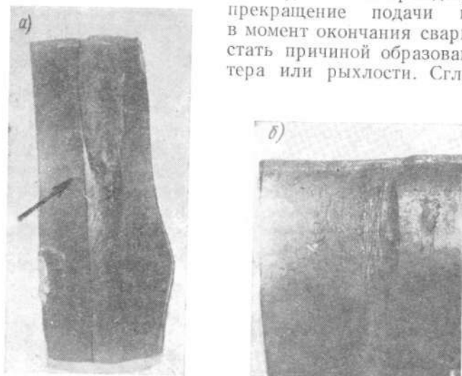
Рис. 121. Несквозная рыхлость в кратере шва, выполненного автоматической аргоно-дуговой сваркой: а — внешний вид участка окончания сварки; б — внешний вид рыхлости после частичного снятия усиления.
