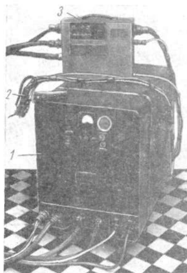
Рис. 27. Полуавтомат «Заря-3». 1 — реостат балластный; 2 — горелка; 3 — подающий механизм.
