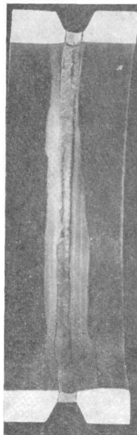
Рис. 112. Уменьшение сечения шва (утяжка) на участке трубы, сваренном в потолочном положении стыка.
