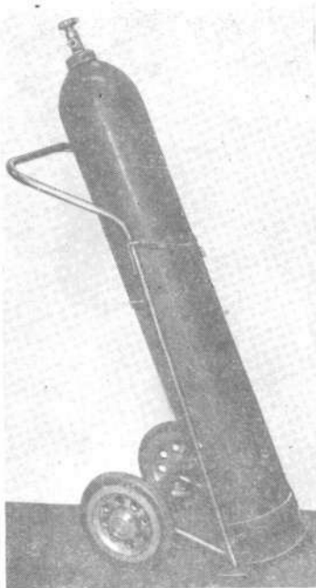
Рис. 143. Тележка для транспортировки баллонов со сжатым газом.
