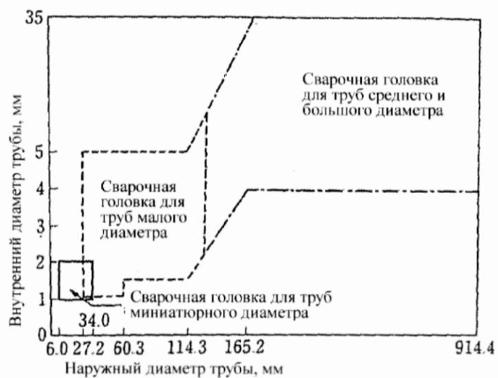
Рис. 5.16 Диапазон применения сварочных головок разного вида
