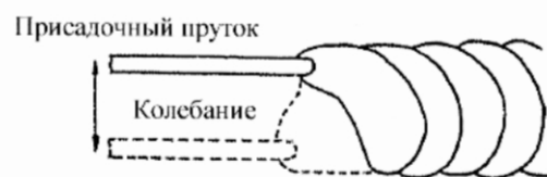
Рис. 4.36 Положение добавленного присадочного прутка при придании поперечного колебания
