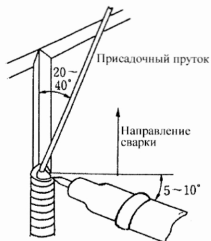
Рис. 4.34 Прибавка присадочного прутка при вертикальной сварке снизу-вверх
