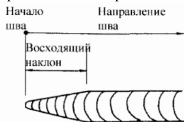
Рис. 4.5 Форма валика в начале шва
