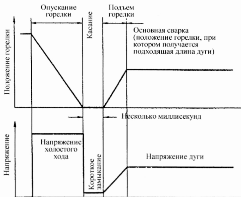
Рис. 4.16 Контактный метод зажигания в сварочном автомате
