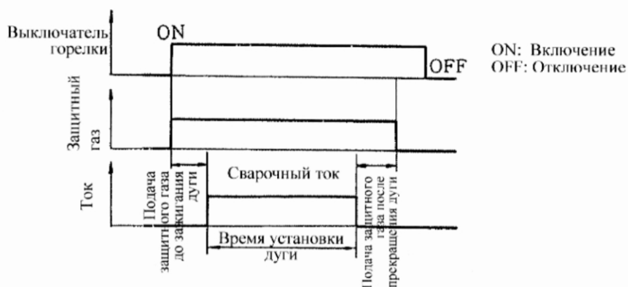
Рис. 4.10 Последовательность действий точечной дуговой сварки (1)
