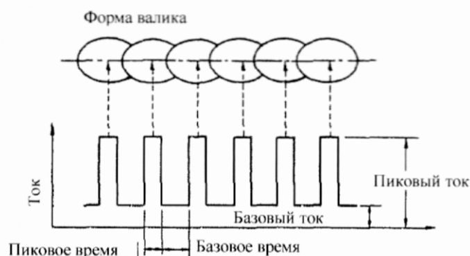
Рис. 4.51 Принцип дуговой сварки на низкочастотном импульсе
