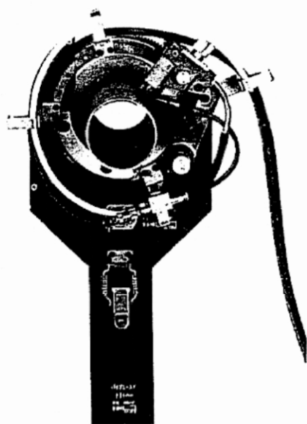
Рис. 5.18 Сварочная головка для труб малого диаметра
