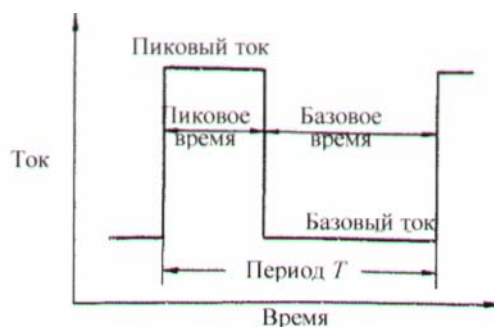
Рис. 2.10 Форма волны тока в импульсно-дуговой сварке на постоянном токе
