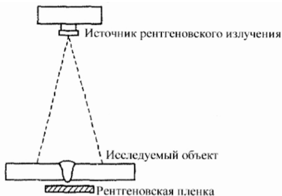
Рис. 4.67 Рентгенодефектоскопия
