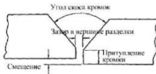
Рис. 3.4 Наименование конструктивных элементов кромок
