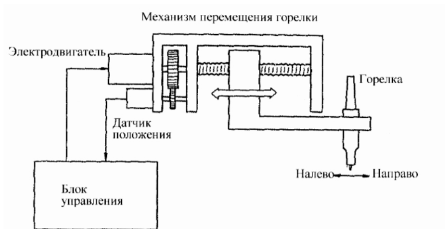
Рис. 5.4 Устройство колебательных движений
