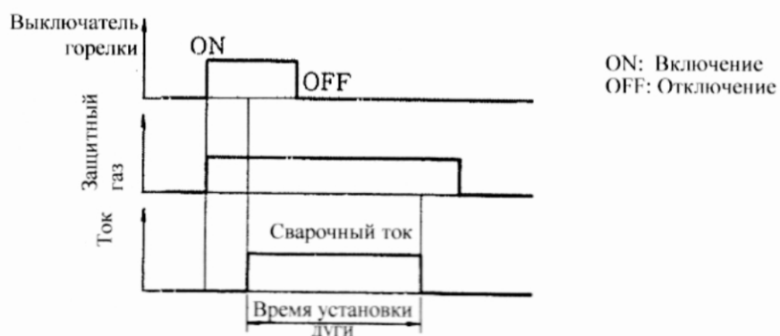
Рис. 4.11 Последовательность действий точечной дуговой сварки (2)
