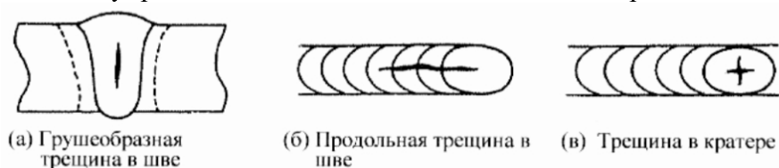
Рис. 4.57 Основные горячие трещины
