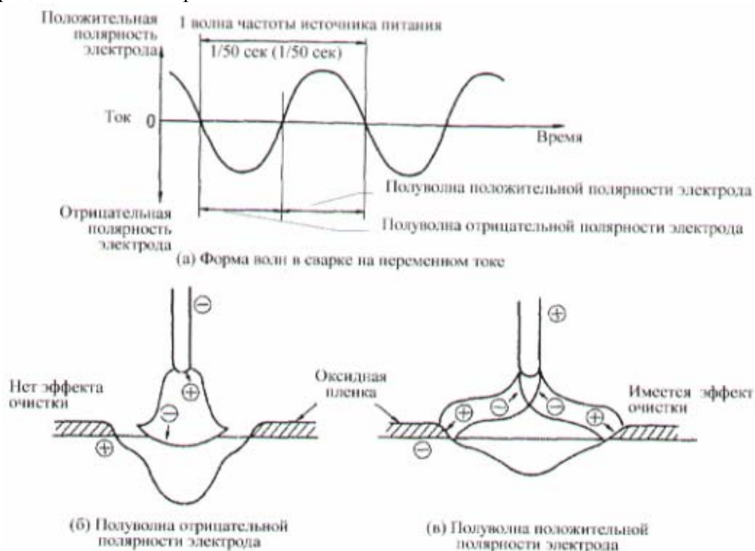
Рис. 1.4 Характеристики дуги в аргонном газе на переменном токе
