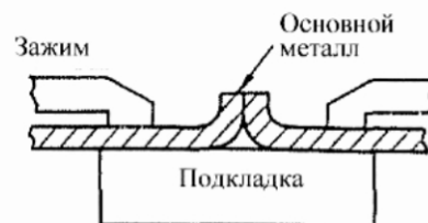
Рис. 4.44 Приспособление-подкладка
