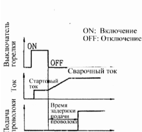
Рис. 4.42 Управление задержкой подачи проволоки
