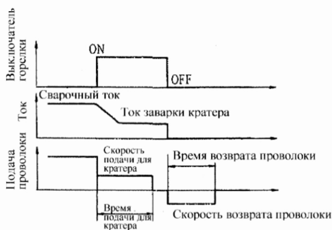
Рис. 4.43 Управление подачей для кратера и управление возвратом проволоки
