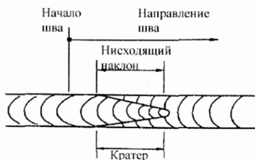
Рис. 4.6 Форма соединения между валиками
