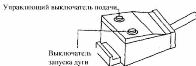
Рис. 4.39 Спаренный выключатель горелки
