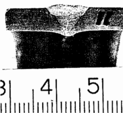
Рис. 5.22 Поперечное сечение стыкового соединения
