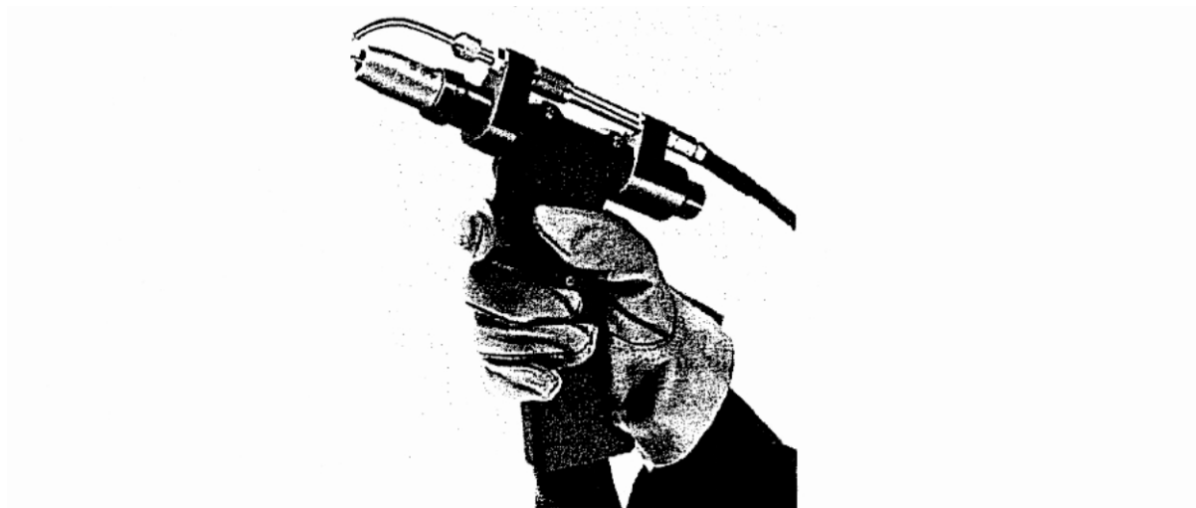
Рис. 4.41 Горелка пистолетного типа для полуавтоматической Аргонодуговой сварки
