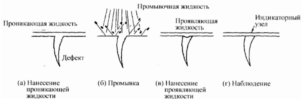
Рис. 4.72 Капиллярная дефектоскопия
