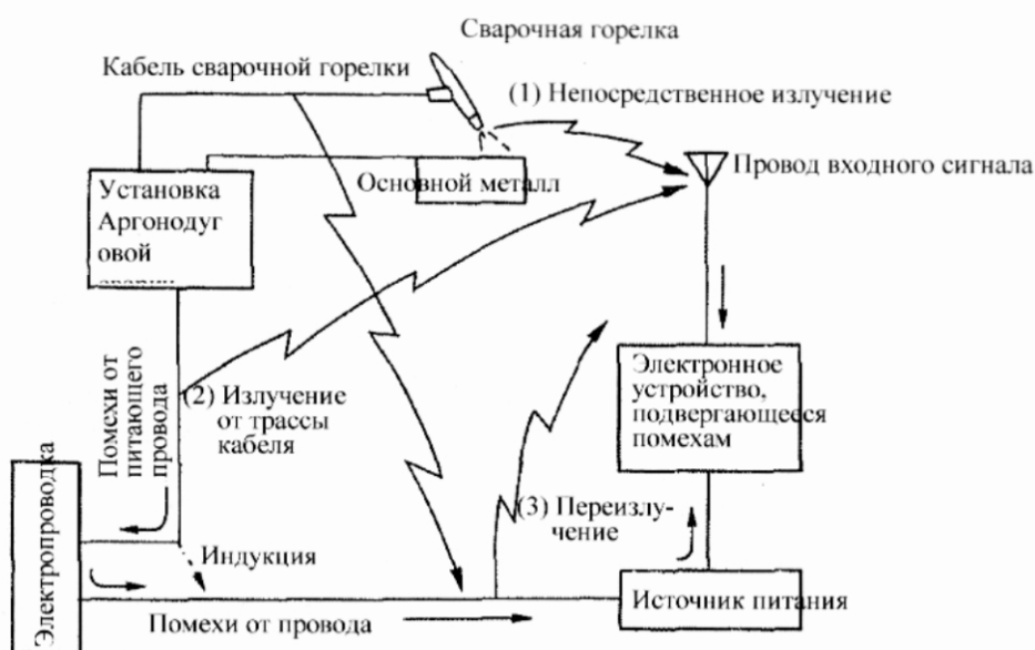
Рис. 3.3 Диапазон распространения высокой частоты
