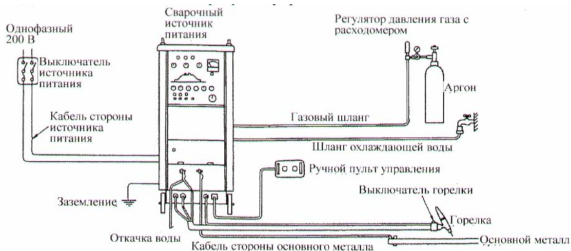
Рис. 2.1 Конфигурация установки Аргонодуговой сварки с встроенным блоком управления
