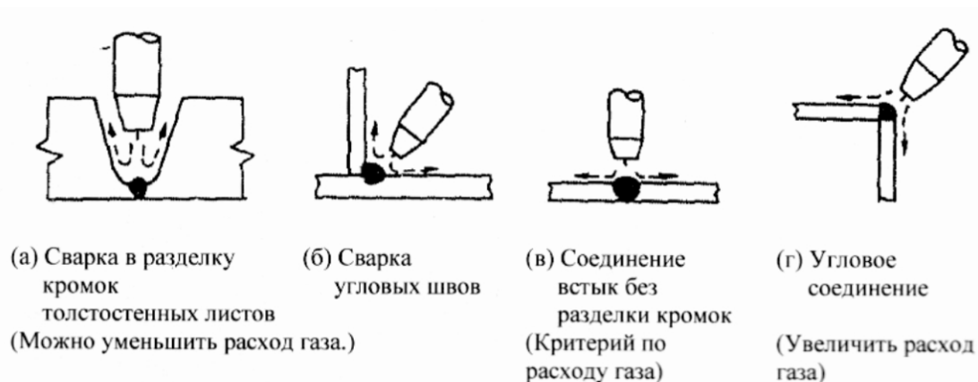
Рис. 3.6 Форма соединения и расход газа
