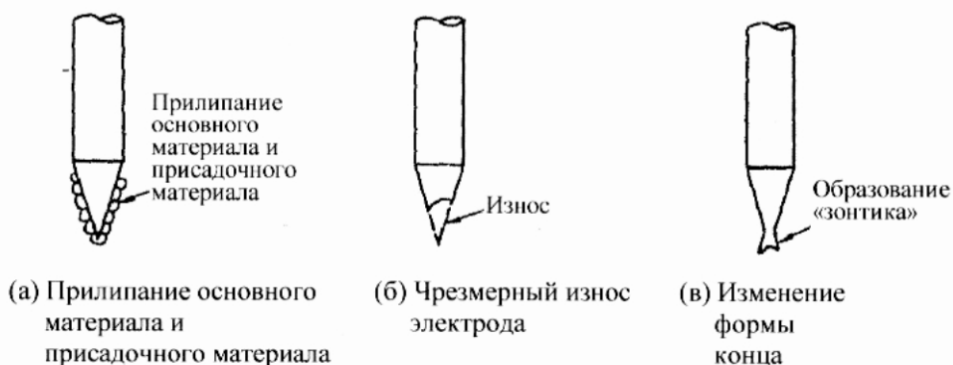
Рис. 4.21 Изменение формы конца электрода
