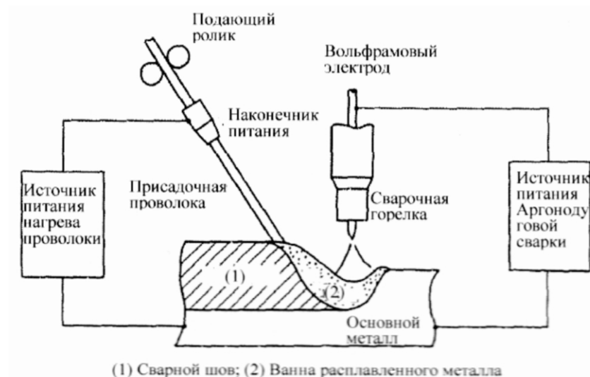
Рис 5.11 Сварка TIG нагретой проволокой
